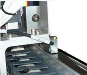
使用线性编码器能够达到最高定位精确度并实现可重复性的功能
